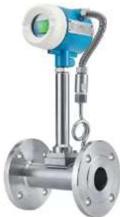
Вихревой расходомер с компенсацией температуры и давления использует принцип вихревой установки Кармана, датчик имеет встроенный пьезоэлектрический кристалл и интегрированную функцию измерения температуры и давления, что позволяет измерять температуру и давление газа, обеспечивая более точный объемный или массовый расход.
